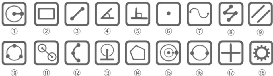
① **圆半径测量:** 鼠标点击按钮后, 在界面中任一点点击确定圆心, 第二次点击确定与圆心距离, 测量显示为半径。
